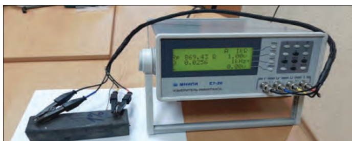
Рис. 3. Определение электропроводности образцов с помощью измерителя-иммитанса E7-20
