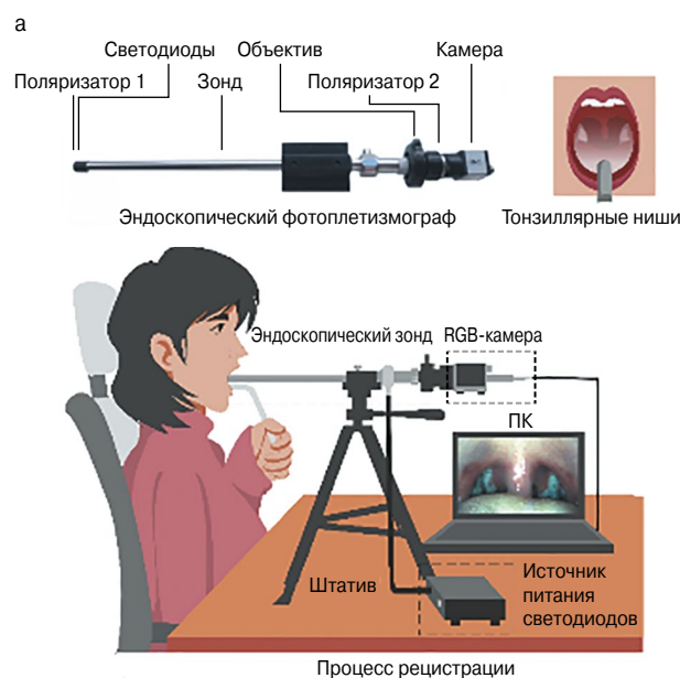
Рис. 1. Экспериментальная установка для неинвазивного мониторинга кровенаполнения СО тонзиллярных ниш: а – схема; б – реализация.
