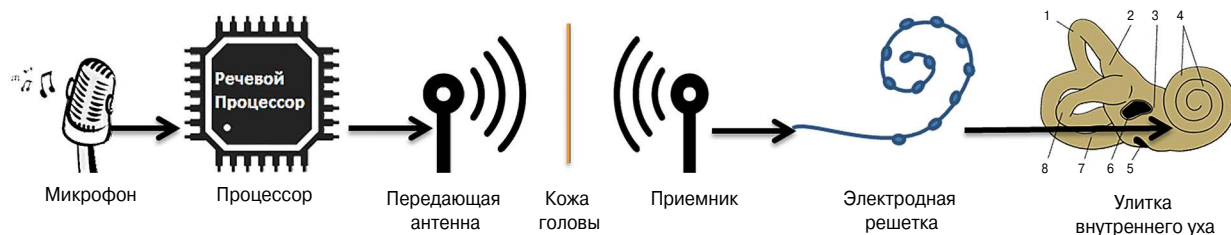
Рис. 2. Принцип работы кохлеарного импланта.
