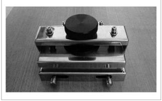
рация) мешающих веществ персульфатом аммония проводится в полипропиленовом микропланшете, помещенном в специально разработанную герметичную кассету (рис. 1) и нагретом до 90–110°С, в течение 60 мин. Далее образцы переносятся в полистироловый микропланшет для проведения реакции Санделла–Колтхоффа при 25°С в течение 30 мин, после чего концентрация йода считывается на микропланшетном ридере при 405 нм. Образование токсичных отходов при этой процедуре сведено к минимуму.
