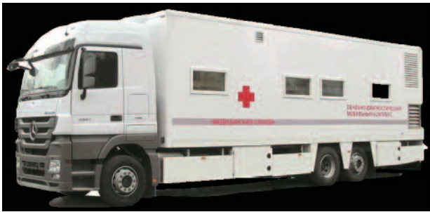
Рис. 5. Мобильный комплекс «ПКЛ-КТ» на базе шасси автомобиля MERCEDES сборки КАМАЗ с изменяемой геометрией кузова (внешний вид и внутренняя компоновка).
