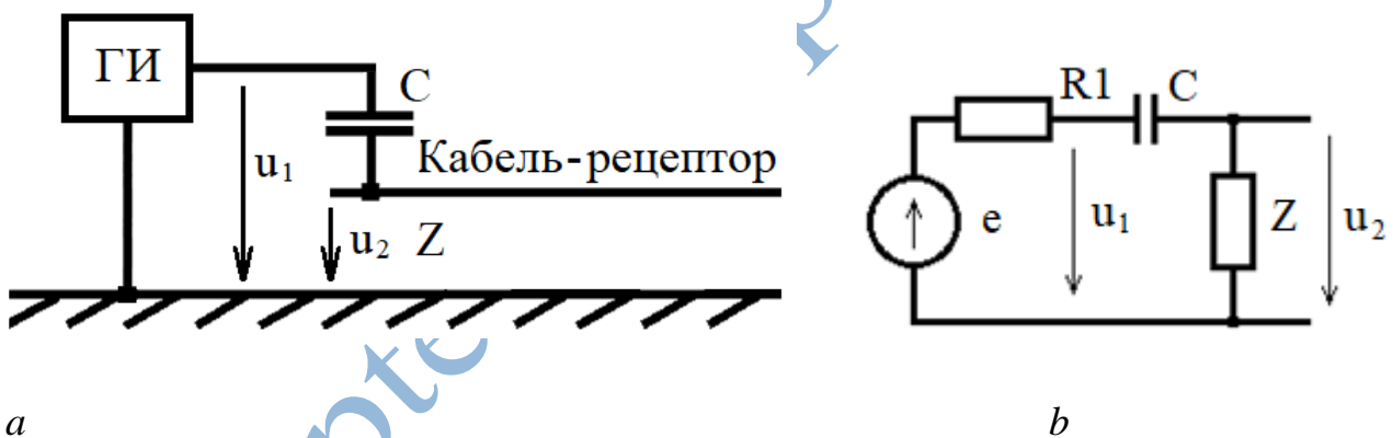
Рис. 2. Схема расчета напряжения на кабеле при воздействии косвенного электростатического разряда: a — расположение элементов; b — упрощенная схема замещения.
